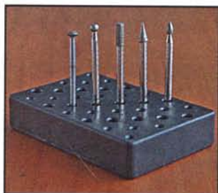
Боры с алмазным напылением (линза, шар, цилиндр, конус и капля) для гравирования твёрдых материалов (стекла, керамики или фарфора). С помощью таких инструментов можно нанести рисунок на стекло.
