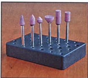
Шлифовальные насадки из карборунда (шайба, цилиндр, пуля и конус) для обработки твёрдых материалов (стекла, керамики, стали и чугуна).
