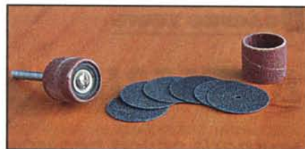
Зачистные насадки для шлифования внешних либо внутренних поверхностей. Их делают из шкурки разной зернистости. Кольца из шлифовальной шкурки устанавливаются на специальный резиновый валик соответствующего диаметра.
