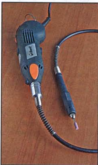
Бормашина Vort с гибким валом и цилиндрической шлифовальной насадкой из карборунда. Гибкий вал ещё больше расширяет возможности бормашины.
