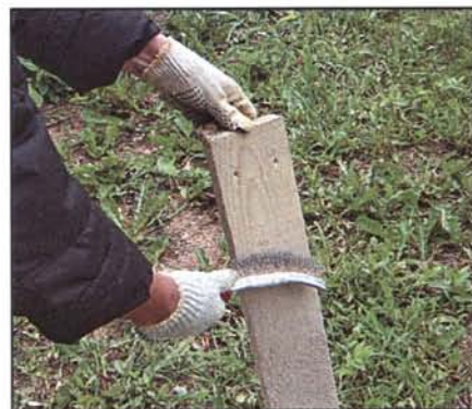
После такой обработки щёткой доска уже не страшна режущему инструменту. Только чистить надо сухие доски.
