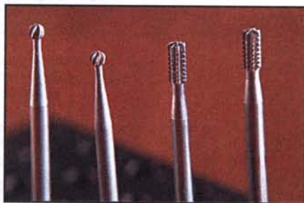
Стоматологические фрезы используют для обработки цветных металлов, твёрдых пластиков, древесины.
