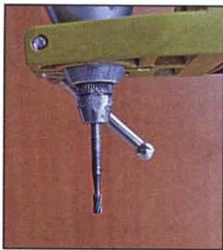
Цилиндрическая фреза для обработки цветных металлов и твёрдых пластиков.
